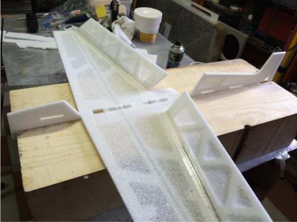
**Collage fuselage horizontal et cockpit.**
